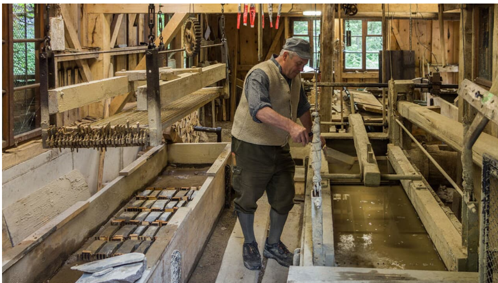
Die Steine werden in 2 cm breite Streifen gespalten (links), rechts werden die Steine auf die Breite von 4 cm zugeschnitten - © Ammergauer Alpen GmbH
